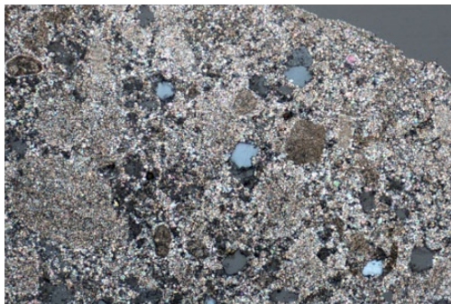
Detalle de la muestra del soporte pétreo EP19.2P. microscopía óptica con fuente de luz visible, 20x-XN. Se observan las formas de los bioclastos mineralizados por el proceso de dolomitización
