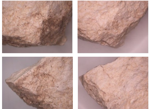
Imagen de fragmento de soporte pétreo. A la izquierda se observa la superficie sin tratar; a la derecha, la superficie tratada. Microscopía estereoscópica, 0,8x
